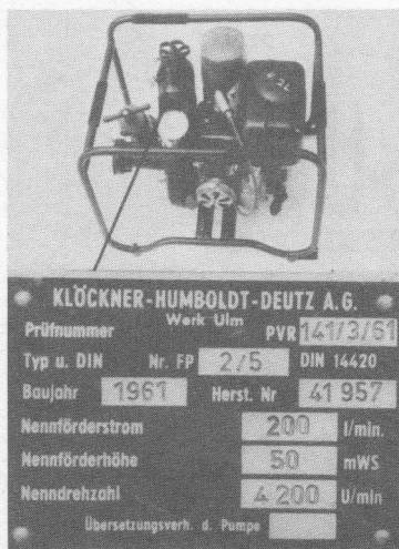
Bild 4 Kennzeichnungsstelle der Tragspritzpumpe TS 2/5
